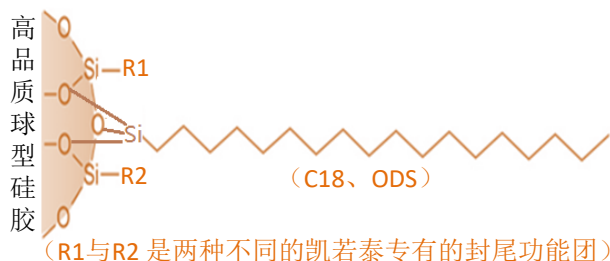
图(A). 凯若泰™ ODS-RPS固定相的键合示意图
