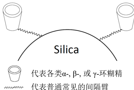
图(B).其他厂商的基于环糊精的固定相的键合示意图
