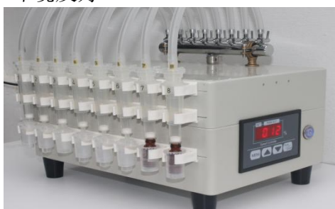
图(A). 凯若泰PSPE-08A型萃取仪照片
